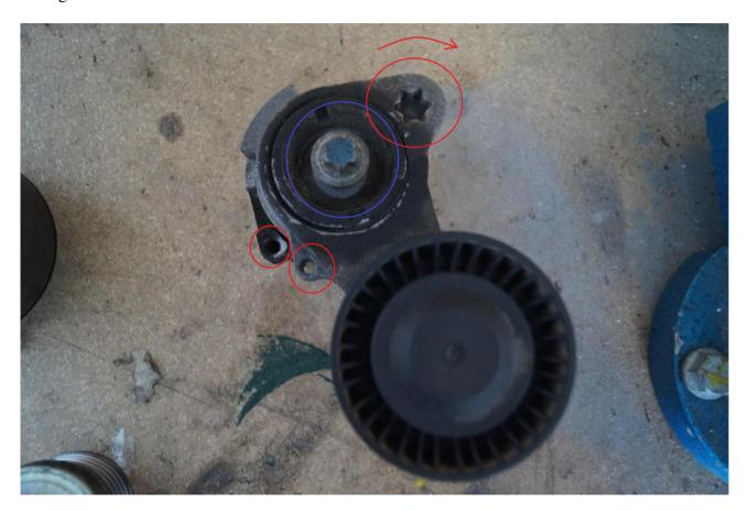
Die Umlenkrolle is am Generator angeschraubt. Zum wechseln die Abdeckkappe abhebeln, die Schraube lösen (verbleibt an der Rolle) und die Umlenkrolle abnehmen.
