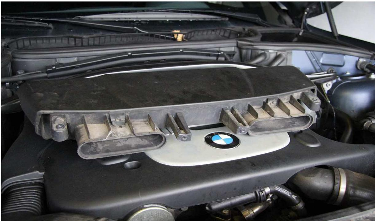
Nun müssen wir die große Motorabdeckung demontieren. Dazu müssen die 5 Innensechskantschrauben gelöst werden. Achtung, die rot gekennzeichnete ist eine längere Schraube und muss auch dort wieder rein.
