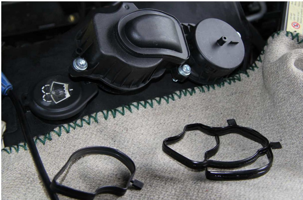
Ist die neue KGE wieder eingebaut kann auch die Kabelbahn und die hintere Motorabdeckung wieder montiert werden.
