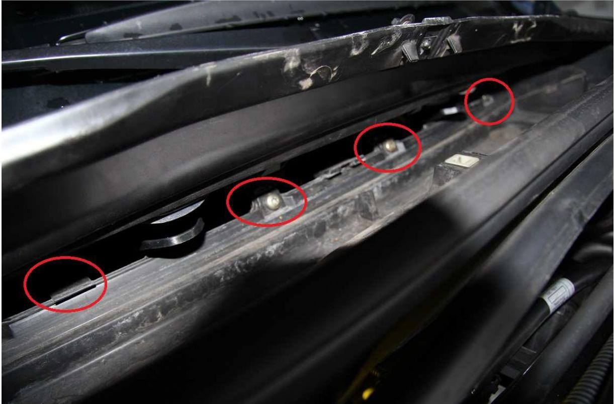
Ist der Kasten draußen können auch die letzten beiden Schrauben vom Luftfilterkasten gelöst werden. Um diesen nun aber abzunehmen müsst ihr den Öleinfülldeckel abschrauben. Achtung, lasst nichts in die Einfüllöffnung fallen!!! Wenn ihr das Kunststoffteil runter habt muss direkt der Deckel wieder aufgeschraubt werden.
