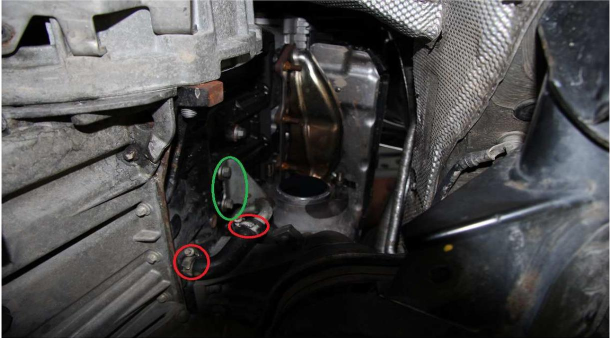
Jetzt muss unten nur noch der Unterdruckschlauch zu Unterdruckdose gelöst werden. Leider habe ich auch dort kein Bild machen können, daher zeig ich es euch an einem extra Bild. Rot, das ist der kleine Anschlussnippel für den Unterdruckschlauch der von der Unterdruckpumpe kommt. Einfach abziehen und den Clip lösen der den Schlauch noch am Turbolader festhält.
