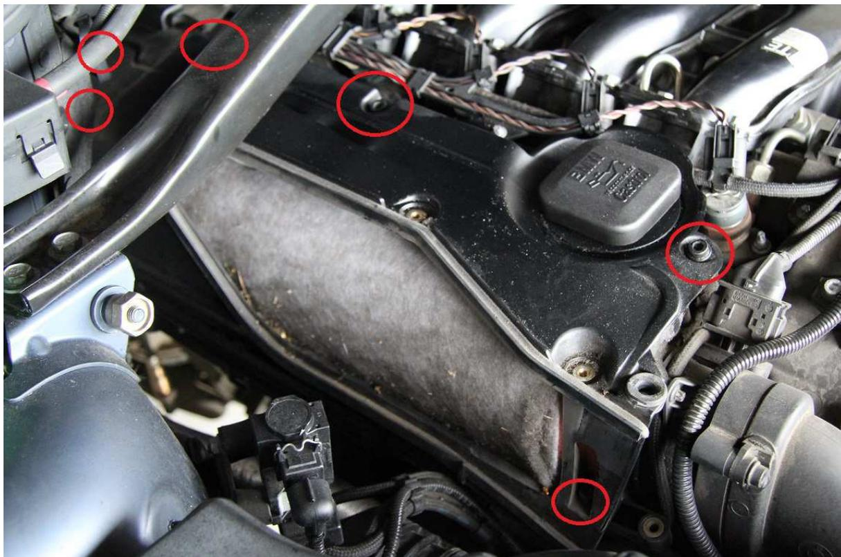
Den Pollenfilterkasten öffnen und den Filter entnehmen. Dann auch gleich den Kabelkanal öffnen und die Leitungen heraus nehmen. (grün)
