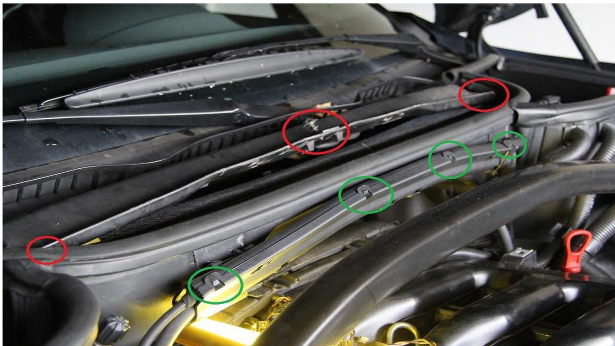
Nun müssen die Befestigungsschrauben gelöst werden (rot) ... danach kann der Kasten schon entfernt werden.
