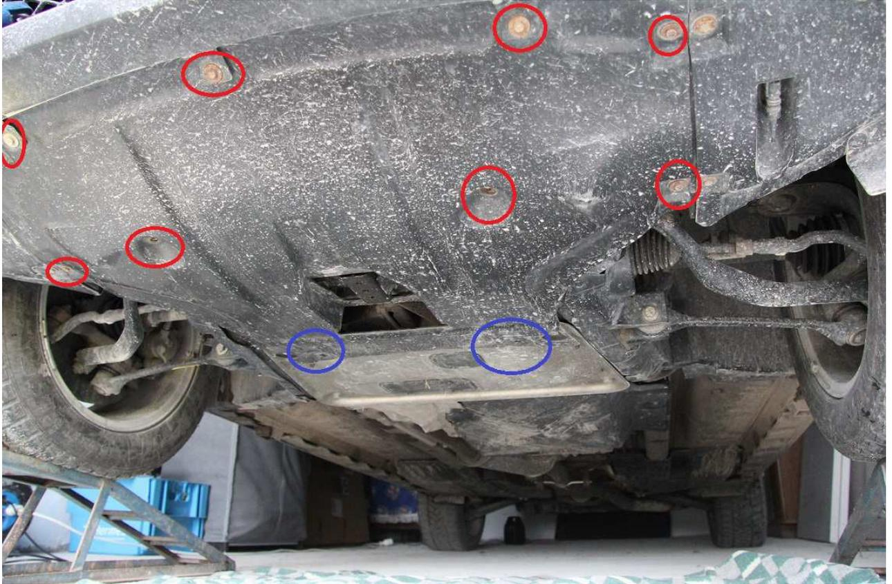
Blau gekennzeichnet sind zwei Spreizniete, oft gehen diese kaputt, deshalb gleich Ersatz mit bestellen. Rot gekennz. sind Blechschrauben mit einer 8er Sechskant Schlüsselweite
