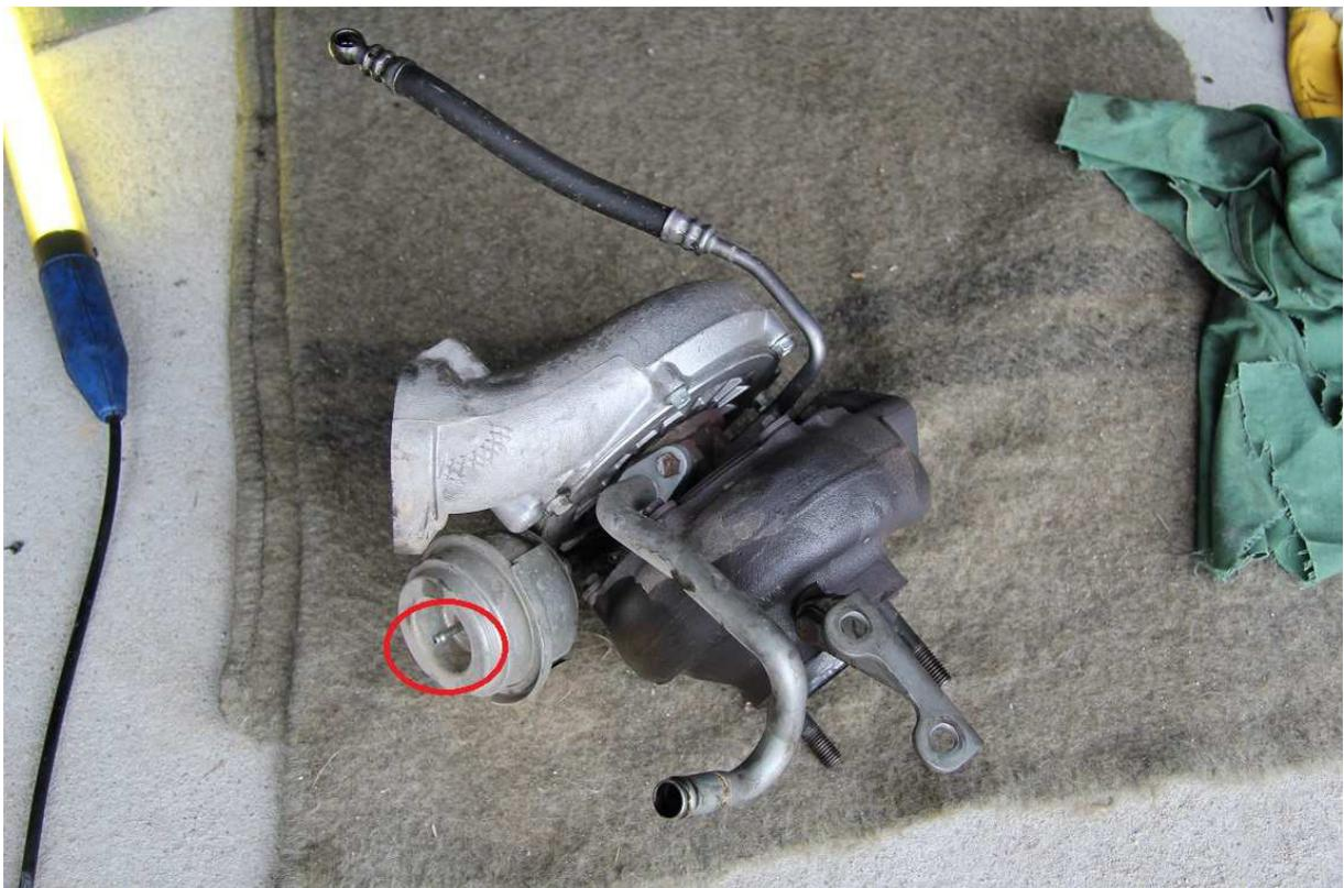
Wenn alle Leitungen vom Lader gelöst sind (Ölzufuhr, Ölrückführ, Ladedruck, Luftenlass, Unterdruck) gucken wir wieder von oben in den Motorraum. Nun müssen die Abdeckungen von den 3 Löchern
