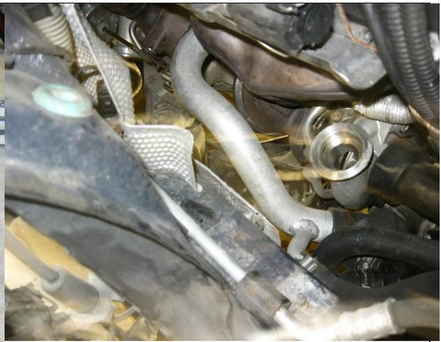
8. Danach hatte ich die Steuerung und die Leiste für die Unterdruckschläuche abmontiert. Das waren für die zwei Steuerungen 4 Muttern und für die Leiste (an der Unterseite) ich glaube 3 – 4 Schrauben
