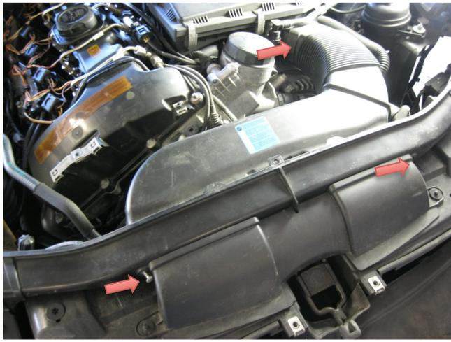
4. Lüfter Ausbauen (eine Schraube Oben rechts bzw Beifahrerseite, eine Schraube unten Links(wenn wagen oben ist abmachen). Der Lüfter wird nur von oben eingefahren. Auf der Beifahrerseite ist eine Führung und auf der Fahrerseite auch jedoch muss diese entriegelt werden,
