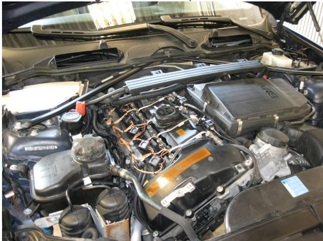
Lufführung abschrauben (2 Schrauben) und am Luftfilterkasten entriegeln
