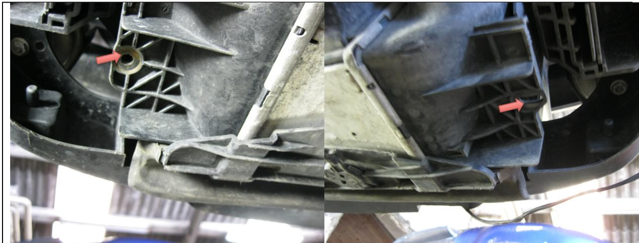
6. Nun habe ich die Unterdruckdosen und den Ausgleichsbehälter vom Kühlmittel ausgebaut. Der Ausgleichsbehälter wird von zwei Schrauben gehalten. Diese entfernen und den Zu und Rücklaufschlauch entriegeln. Achtung unten ist noch ein kleines Kabel zu einem Sensor! Dieses vorsichtig abstecken.
