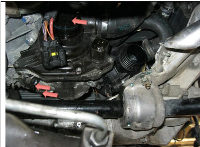
(Auf höhe der Pfeile sind ungefähr die Schrauben angebracht und sehen genauso aus wie die Schrauben auf dem Bild mit dem blauen Punkt.)
