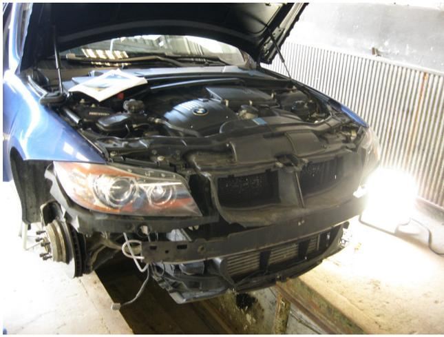
3. Motorhaube auf, Innenraumfilterabdeckung, Windleitblech etc. ausbauen hierzu am besten die Anleitung vom JB4 hernehmen, da man dafür auch alles demontieren muss.
