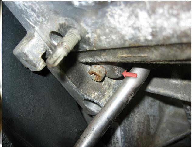
13. So sieht es dann aus wenn die Turbos etc. draußen sind. Ich hatte noch die Möglichkeit mit einem Endoskop in die Auslässe zu schauen und die Aulassventile überprüft. Sahen eigentlich ganz gut aus! Hab die dann noch mit etwas Druckluft ausgeblasen. Außerdem hatte ich alles gereinigt. Alle Leitungsanschlüsse am Motorblock, die Auslässe von Überresten der Dichtungen befreit.
