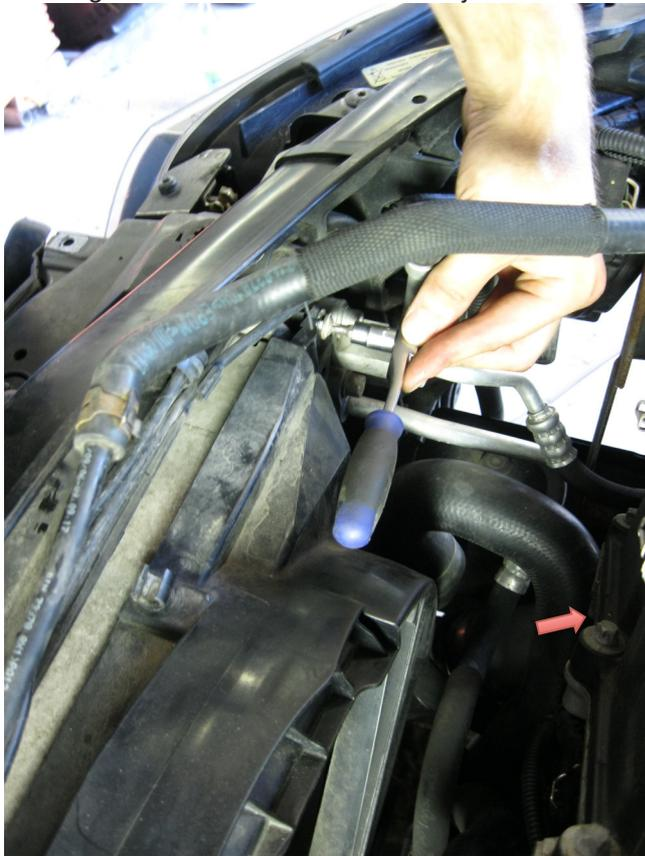
außerdem ist ein Schlauch an dem Lüfter fixiert, diesen einfach abziehen.
