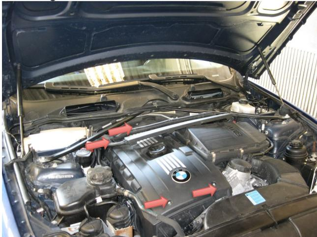
Motorabdeckung abschrauben (4 Schrauben: 2 vorne 2 hinten)
