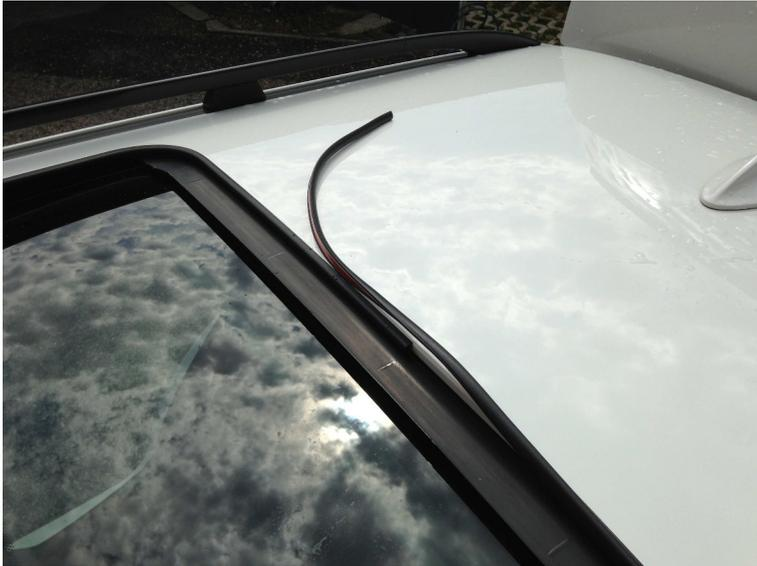
6. Schritt: Sobald ihr den Großteil der Dichtung angeklebt habt und gegen Ende kommt (siehe Foto oben), werdet ihr sehen, dass diese zu lang ist. Um 100% dicht zu sein, müsst ihr die Dichtung exakt und gerade abschneiden und ankleben.
