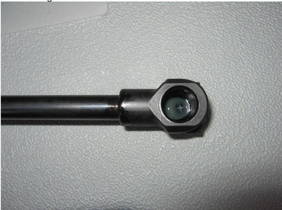
Und hier sieht man die "geschlossene" Position der Klammer, dann wird das Kugelgelenk welches am Auto angebracht ist gehalten.
