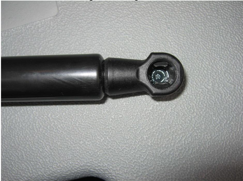
Die alte Feder kann nach dem öffnen der Sicherungsklammern abgenommen werden.
