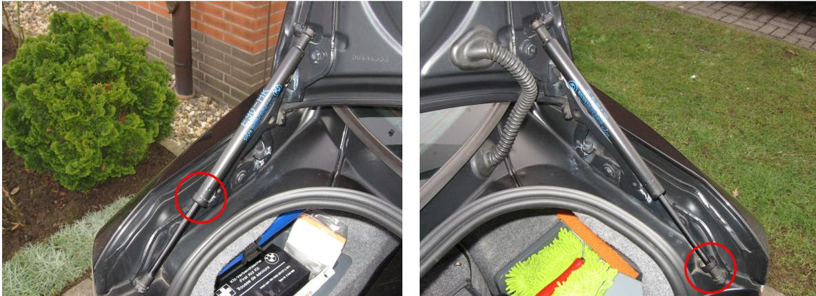
Bei mir hatte sich schon eine Kappe gelöst, weil sie gebrochen war und lag ständig am unteren Ende der Gasdruckfeder.
