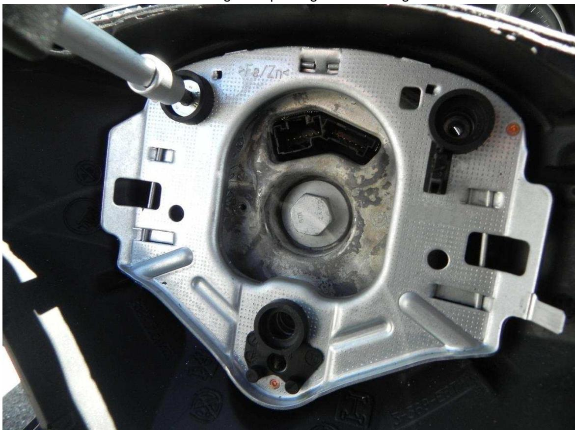
Den Abschluss bildet eine 16er Nuss an einer Verlängerung. Mit kräftigem Druck ist die Schraube wie gewohnt gegen den Uhrzeigersinn zu lösen.
