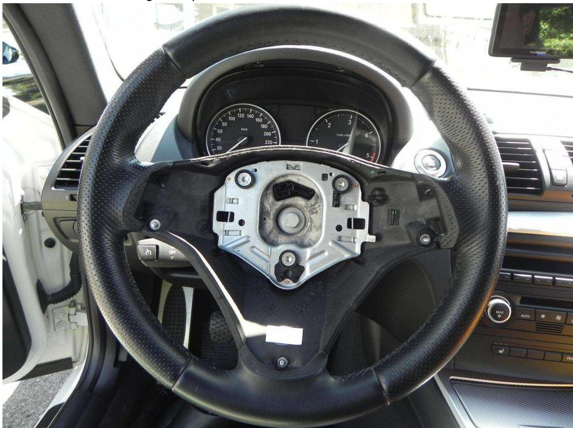
Mit einem 30er Torx wird die Airbag-Halteplatte gelöst. Achtung: 3 Federn auf der Rückseite!
