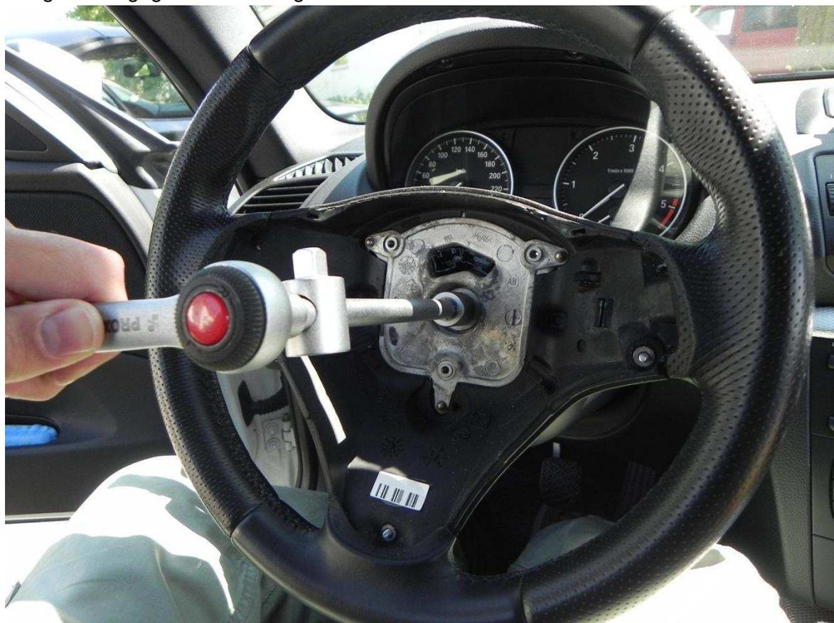
Das Lenkradinnere offenbart den Blick auf die Ausrichtung des Lenkrades. Sofern keine Markierung gesetzt ist, diese mit einem Bleistift ziehen zur geraden Remontage.
