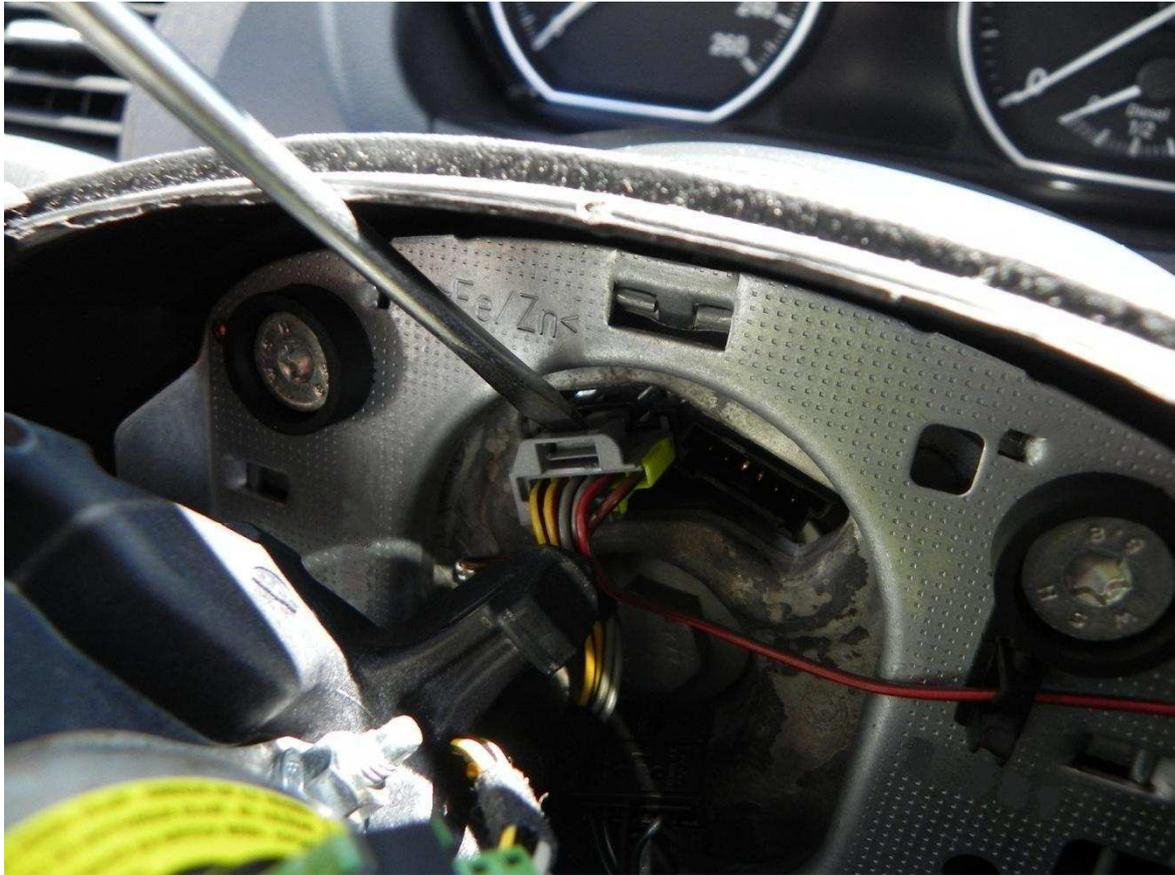
Weiteren Stecker rechts auf der Airbag-Halteplatte abziehen und die Airbag-Erdung (links, nicht auf dem Foto) mit einem 10er Torx-lösen. Den Airbag ohne Kontaktberührung zur Seite legen.
