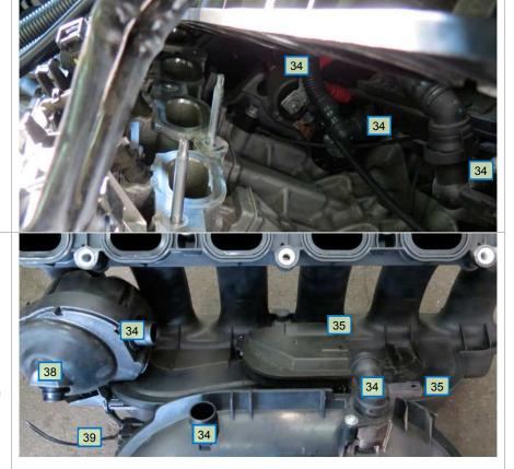
Im gleichen Arbeitsschritt noch alle Stecker der Leitungs- und Ölabscheiderheizungen am Anschlussverteiler (hinteres Ender der Saugbrücke) trennen.
