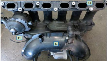
Die Saugbrücke etwas "ablüften" lassen, Reiniger muss vor Montage verflogen sein. Bitte NICHT mit Druckluft ausblasen! Das könnte die Klappen im Inneren zerlegen. Regelmäßig Reinpusten geht auch, aber bitte ohne Kippe in der Hand :)
