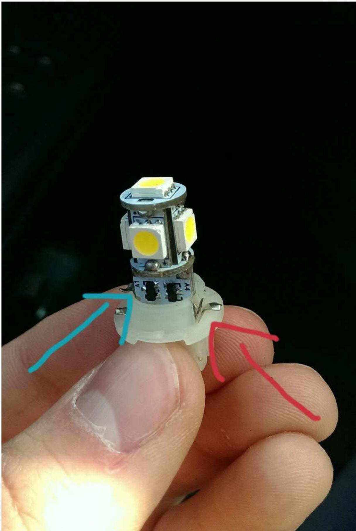
Beim blauen Pfeil ist dieses „Metall-Teil“, welches noch heil ist. Beim Roten Pfeil ist dieses „Metall-Teil“ beim reindrücken der LED abgebrochen. (Hatte die Schaltzentrale nicht ausgebaut, sondern die LED einfach reingedrückt)
