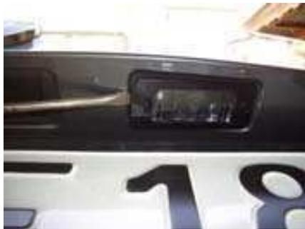
Zuerst sehr vorsichtig einen Schraubendreher links unter den Kunststoff der Kennzeichenbeleuchtung schieben und nach gefühlvollem Druck rastet die Beleuchtung aus. Dann die Einheit etwas nach links schieben und schon kann sie nach unten herausgenommen werden.
