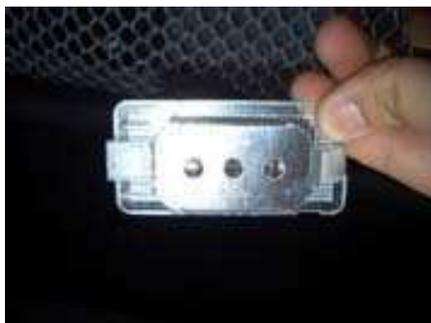
Jetzt das Blech, durch zur Seite schieben, entriegeln und abnehmen und schon ist die Glühlampe erreichbar.
