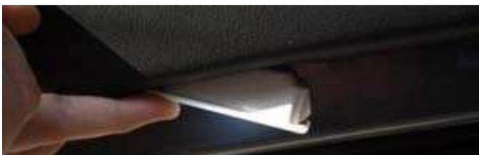
Nun den Deckel auf den Lampenkasten clippen und die Fassung wieder in die Türverkleidung montieren.
