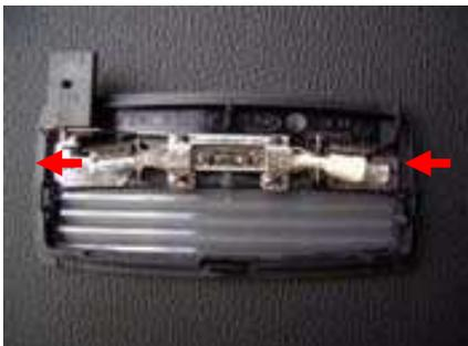
Jetzt einfach die Glühlampen heraus ziehen und die LED Lampen hinein stecken. Wenn die LEDs eingesteckt sind sollte der Halter wieder kurz an den Kabelbaum angeschlossen werden um zu testen ob die LEDs richtig herum eingebaut sind (Spiegelabdeckung in der Sonnenblende öffnen um die Beleuchtung zu aktivieren). Sollte die Beleuchtung nicht funktionieren muss die LED um 180° gedreht werden.
