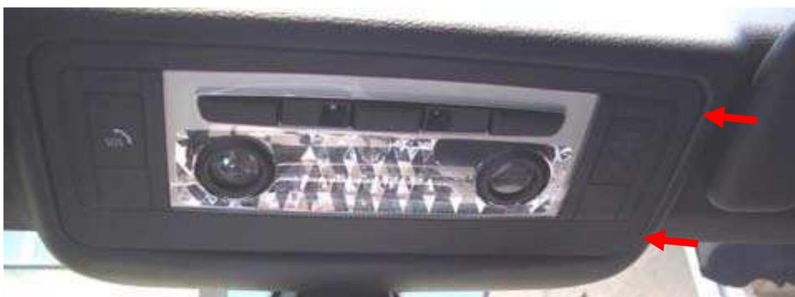
Um die Beleuchtungseinheit aus dem Dachhimmel zu bekommen, kann man entweder mit den Fingernägeln oder einer Plastikkarte an den mit Pfeilen gekennzeichneten Stellen ansetzen und die Einheit vorsichtig nach unten ausrasten.
