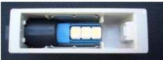
Dann kann die Lampenfassung mit der LED wieder in den „Lampenkasten“ eingebaut werden (hineinstecken und durch drehen verriegeln).
