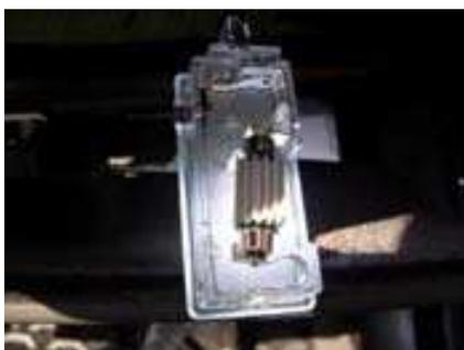
Dann die LED Soffitte einsetzen und die Lampenfassung wieder in die Verkleidung einclippen.
