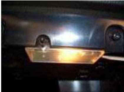
Zunächst die Lampenfassung mit einem Schraubendreher aus der Verkleidung lösen.
