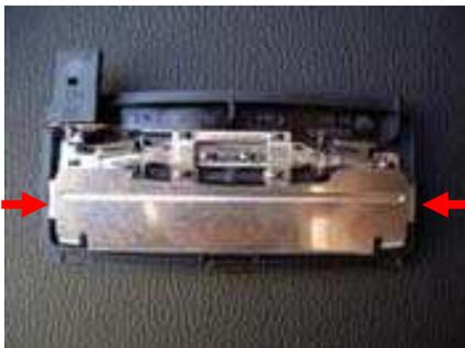
Um das Wechseln der Lampen zu erleichtern sollte das Blech entfernt werden. Hierzu einfach an den mit Pfeilen gekennzeichneten Stellen mit einem spitzen Gegenstand die kleinen Laschen etwas nach innen drücken. Jetzt kann das Blech abgenommen werden.
