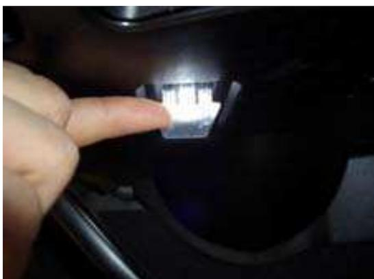
Danach die Fassung an den Kabelbaum anschließen und wieder in die Verkleidung einsetzen.
