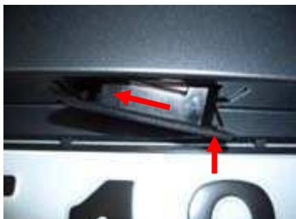
Jetzt kann der Kabelbaum wieder an die Kennzeichenbeleuchtung angeschlossen werden.
