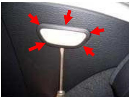
Das Lampengehäuse kann vorsichtig mit einem Schraubendreher an der Unterseite gelöst werden. Sollte das Gehäuse nun noch nicht herausnehmbar sein einfach mit den Fingernägeln oder dem Schraubendreher vorsichtig außen herum arbeiten. Wenn der Kasten aus der Verkleidung ist diesen auch zunächst wieder vom Kabelbaum trennen.
