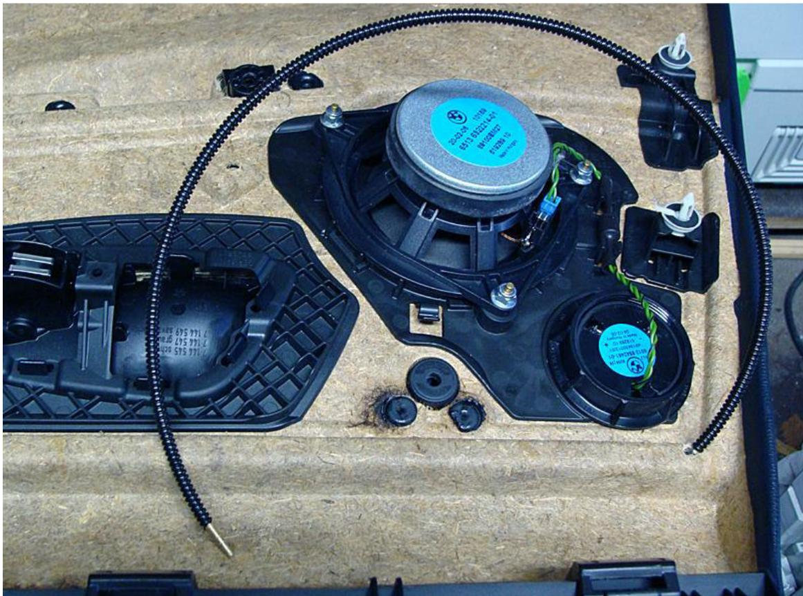
Mit Hilfe einer Heißklebepistole werden nun beide Enden des LWL zur Mitte der Verkleidung verlegt. Es ist nicht notwendig mit dem Zeug „rum zu sauen“, Ein, zwei Tropfen genügen in der Regel, um den Lichtleiter an der Verkleidung zu fixieren.
