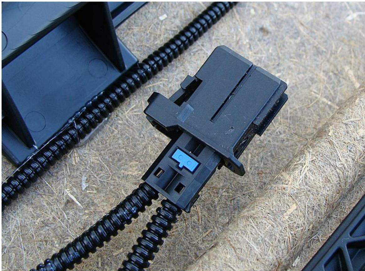
Jetzt montieren wir das Leuchtmittel. Dazu wird das Isolierband im oberen Bereich der Tür entfernt. Mit den Mitgelieferten Stromdieben wird nun die Spannung am Kabelbaum abgegriffen. Am Leuchtmittel ist die braune Ader die Masse und Rot sind die 12V +. Am Fahrzeugkabelbaum ist es in diesem Fall: Braun – Masse und Grau Rot 12V+
