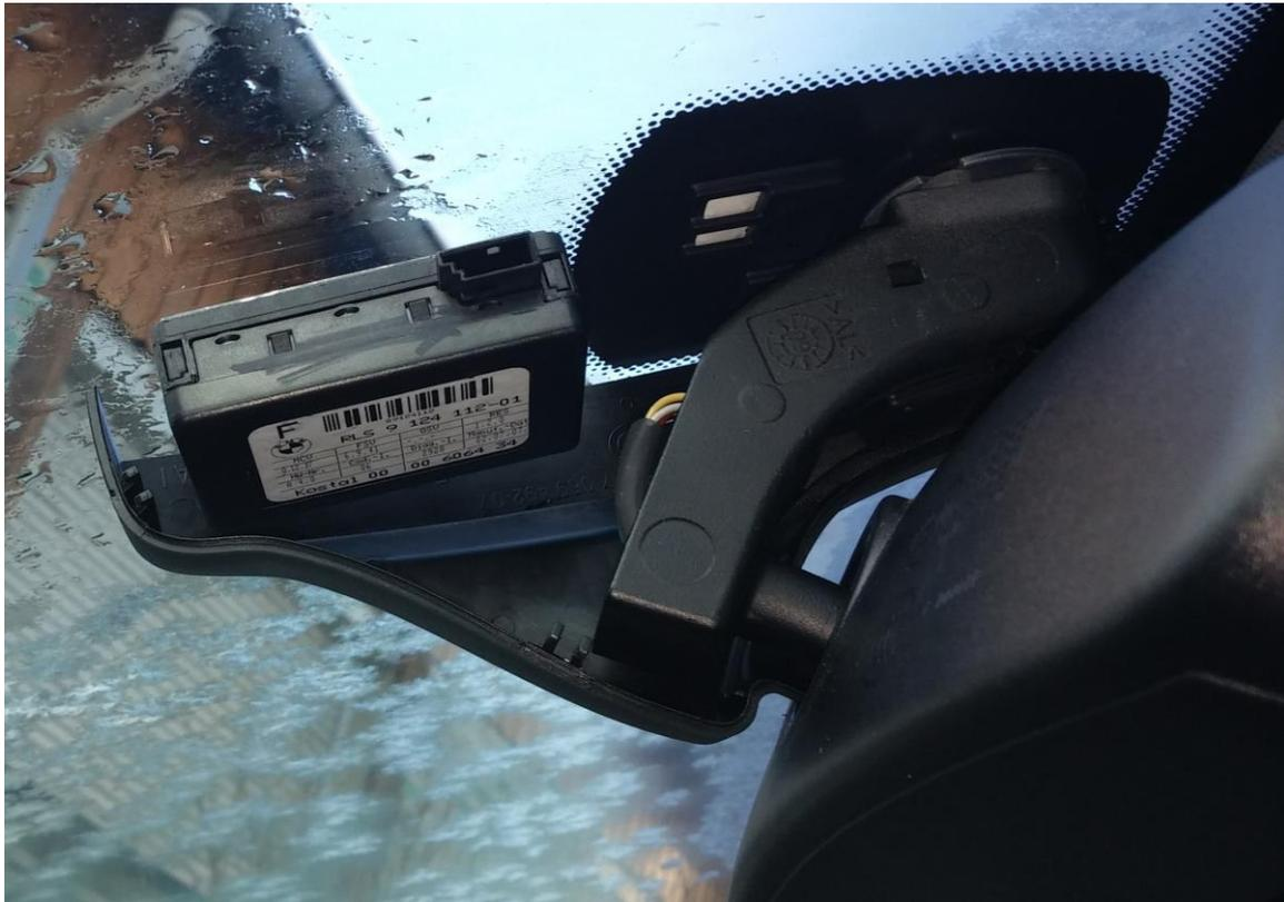
Anschließend die Kabel durch den Gumminippel in den Dachhimmel verlegen. Ihr könnt den Gumminippel oben einschneiden und die Kabel dann durchlegen. Sieht man später nicht weil er direkt unter der Schwarzen Folie liegt.
