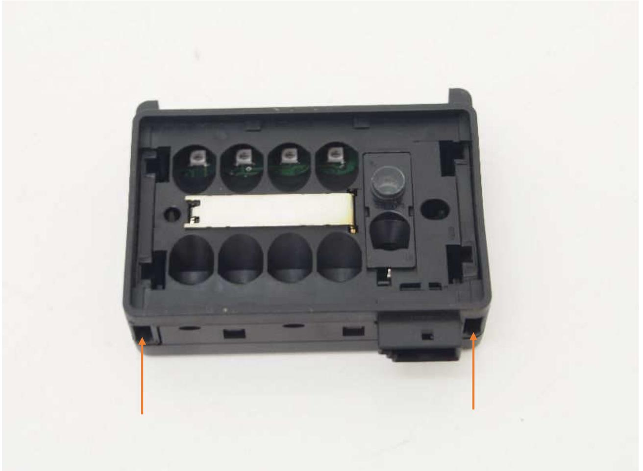
Als nächstes die 3 Kabel mit den Buchsenkontakten „Crimpen“ und eine Seite in das Buchsengehäuse auf Platz 1-3 einstecken, Steckplatz 4 bleibt leer. Die Nummern sind auf dem Buchsengehäuse aufgedruckt. Anschließend den kleinen Clips am Buchsengehäuse schließen um sie zu arretieren.
