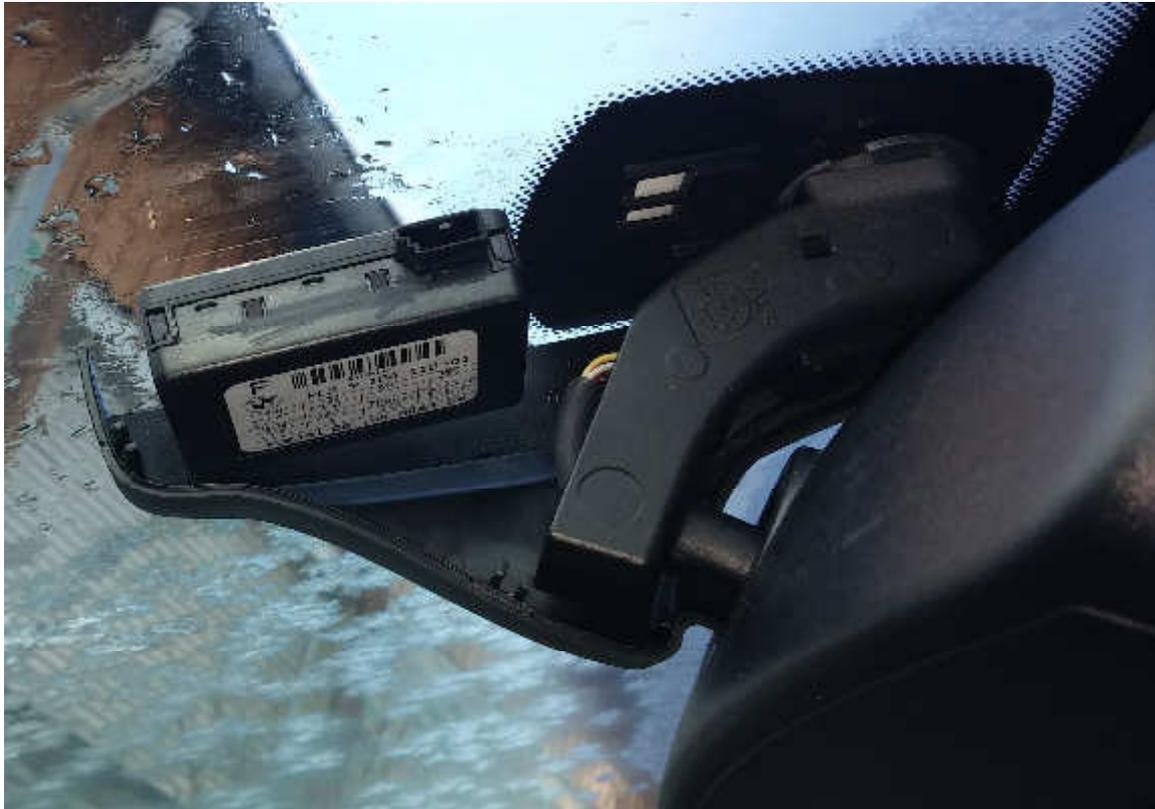
Anschließend die Kabel durch den Gummipfel in den Dachhimmel verlegen. Ihr könnt den Gummipfel oben einschneiden und die Kabel dann durchlegen. Sieht man später nicht weil er direkt unter der Schwarzen Folie liegt.
