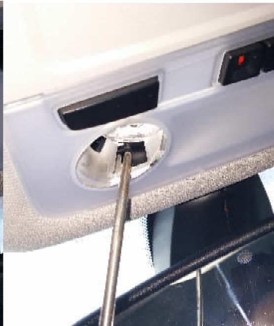
Jetzt könnt ihr die Spiegel Abdeckung entfernen in dem ihr sie einfach auseinander zieht. Sie ist nur gesteckt. Scheibe im Bereich wo der Sensor hinkommt reinigen und fettfrei machen. Dann die rechte Hälfte der neuen Abdeckung aufstecken und den neuen Sensor ganz rechts an der Scheibe applizieren. Aufpassen das der Sensor gerade sitzt, ihr habt nur einen Versuch pro Klebeplättchen und ihr könnt ihn auch nichtmehr verschieben. Der Kleber hält Bombenfest.
