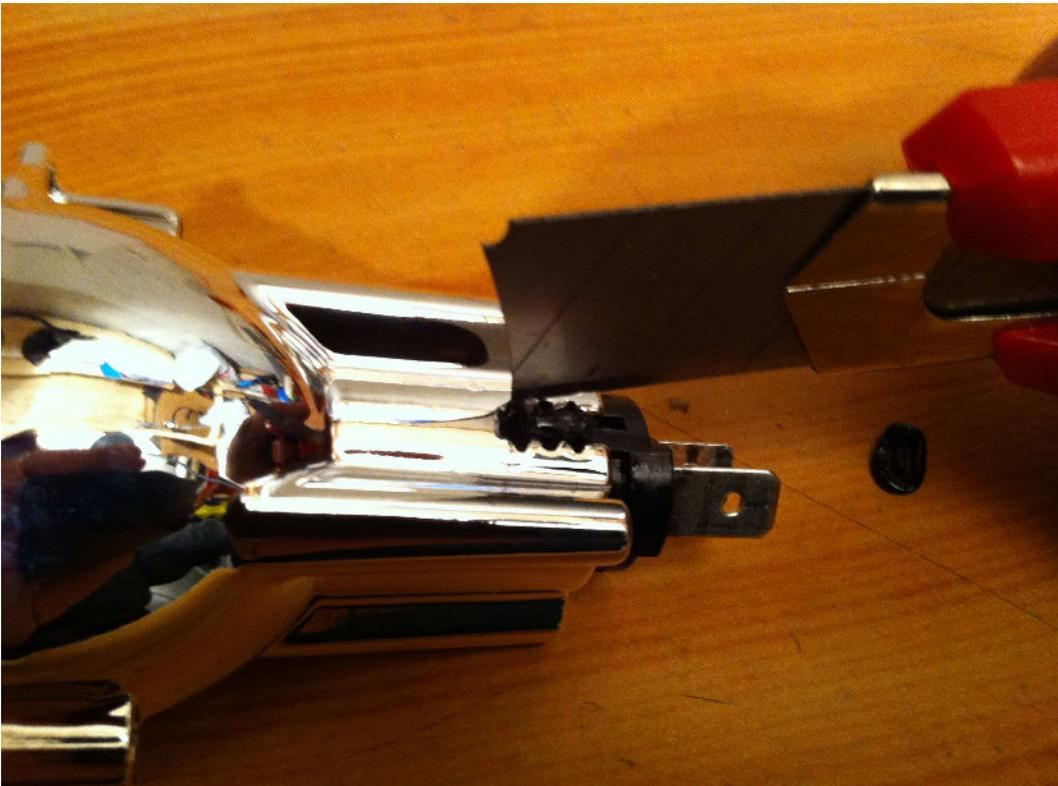
3. Anschließend wird an der Oberseite der schwarzen Kunststoff-Fassung ein Schraubendreher angesetzt und etwas gehebelt, dann kann die Kunststoff-Fassung aus dem verchromten Reflektor nach hinten herausgezogen werden. Geht etwas schwer, nur Mut.
