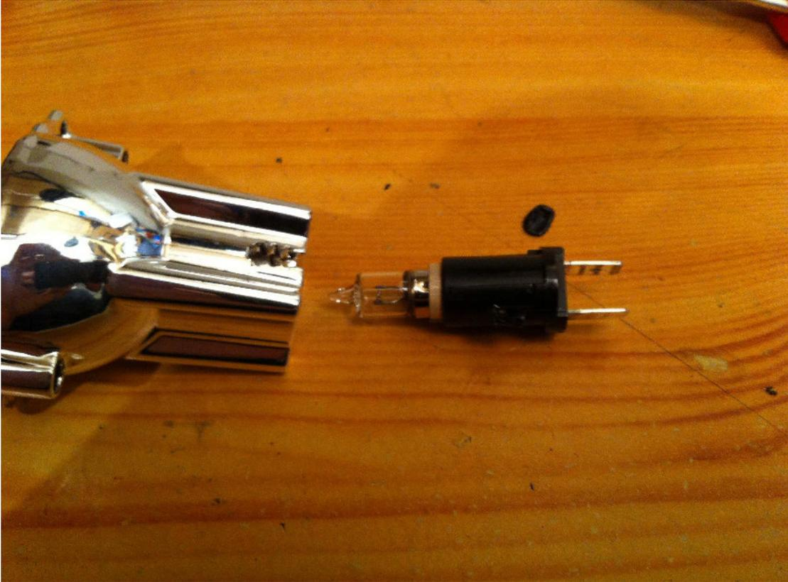
4. Danach kann die Glühbirne mit Druck auf den Glaskörper und einer Drehbewegung ganz einfach aus der Kunststoff-Fassung entnommen werden.
