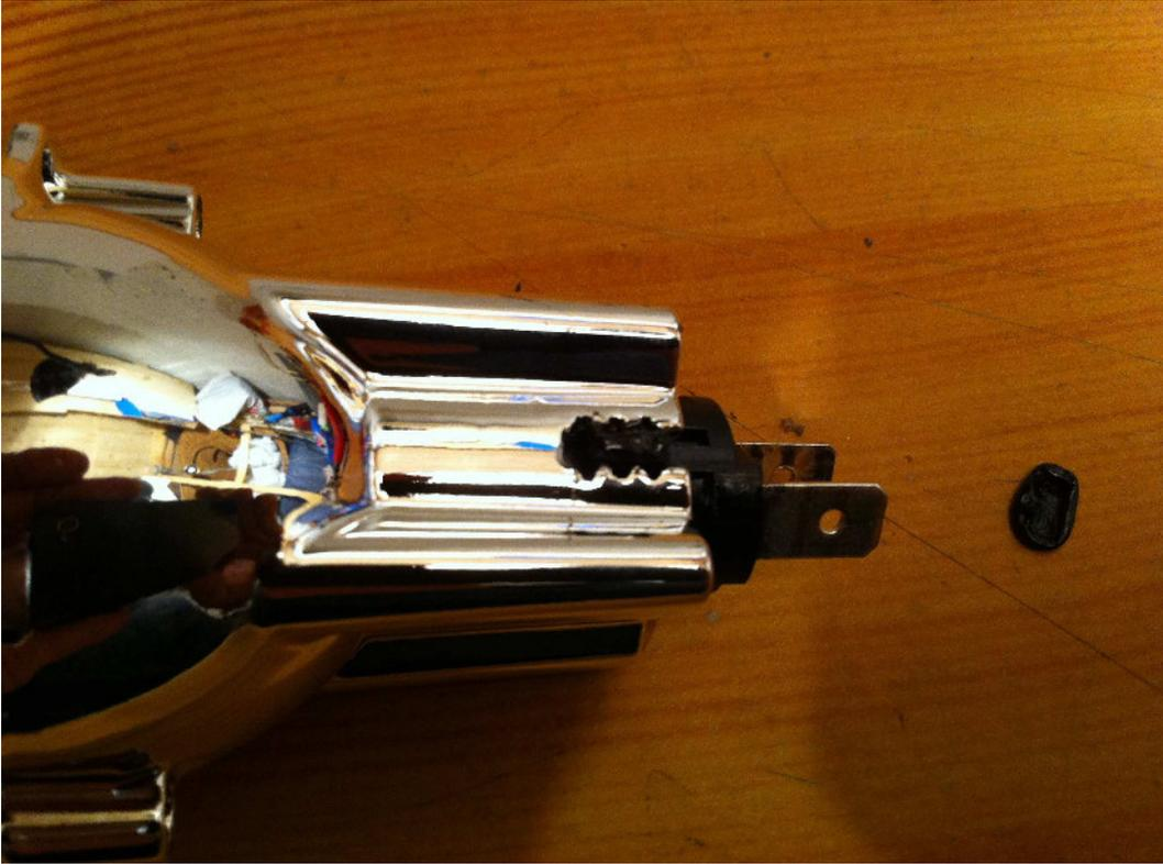
2. Darunter erscheint ein länglicher Spalt. Hier muss links und rechts des schwarzen Kunststoff-Stegs mit dem Teppichmesser eingeschnitten werden (trennt den schwarzen Kunststoff vom verchromten Kunststoffreflektor)
