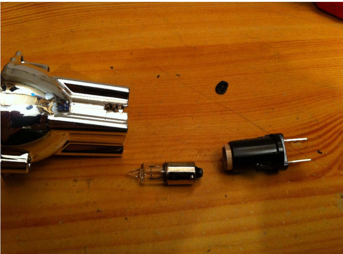
5. Nach Einsetzen der neuen Birne die Kunststoff-Fassung wieder ein den verchromten Reflektor bis zum Anschlag einsetzen. Dann noch zur Sicherheit die beiden Kunststoff-Stege mit einem Tropfen Sekundenkleber o.ä. mit dem verchromten Reflektor verbinden.
