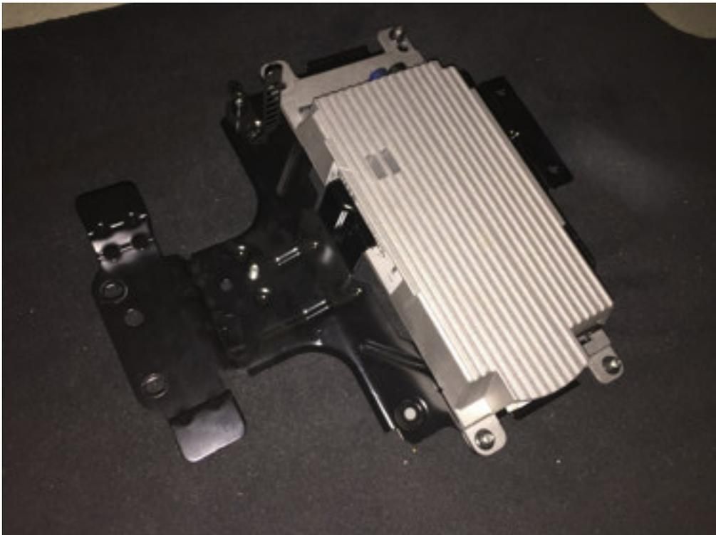
Die Combox Media einfach mit den 4 Muttern auf der Halterung befestigen.
