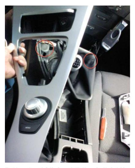
Als nächstes müssen wir die Handbremse kräftig, bis zum Anschlag hochziehen und den Lederbalg, indem wir den schwarzen Kabelbinder runterstülpen, entfernen.
