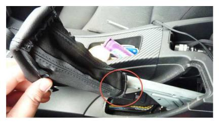
Jetzt die vorhandenen Kabelverbindungen lösen, den Mitteltunnel vorsichtig hochheben und über die Handbremse hinweg entfernen.
