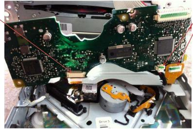
Nachdem alle Leitungen abgezogen wurden, kann die Platine zusammen mit dem Navi-Rechner zur Seite gelegt werden.
