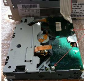
Nachdem die Schrauben gelöst wurden, kann die Platine umgedreht und die vorhandenen Leitungen
