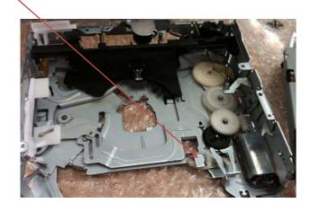
Befindet sich die Lasche am Haltearm nachher nicht unterhalb der Lasche im Gehäuse, kann eine CD / DVD nicht komplett eingezogen werden und bleibt bei der Hälfte stecken.
