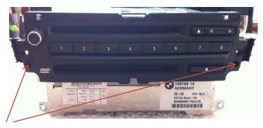
Die Frontblende wird von zwei Torx-Schrauben gehalten. Nachdem diese entfernt wurden, kann die Blende einfach abgenommen werden.
