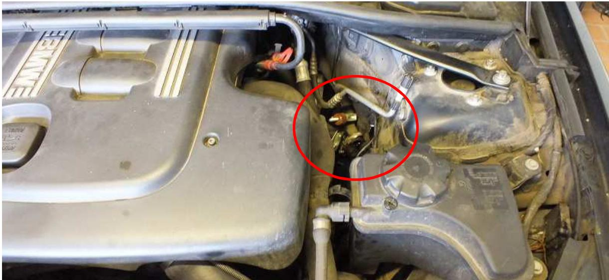
Der Ausbau ist sehr simpel, beide Schläuche abklemmen, das kein Kühlwasser austritt und die Pumpe nach oben herausziehen.
