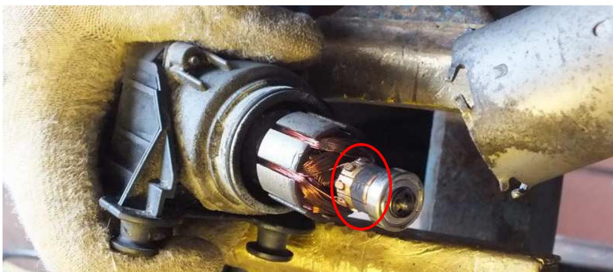
Kollektor mit feinem Schleifpapier reinigen, nur wenig abschleifen und es darf keine ovale Form entstehen.
