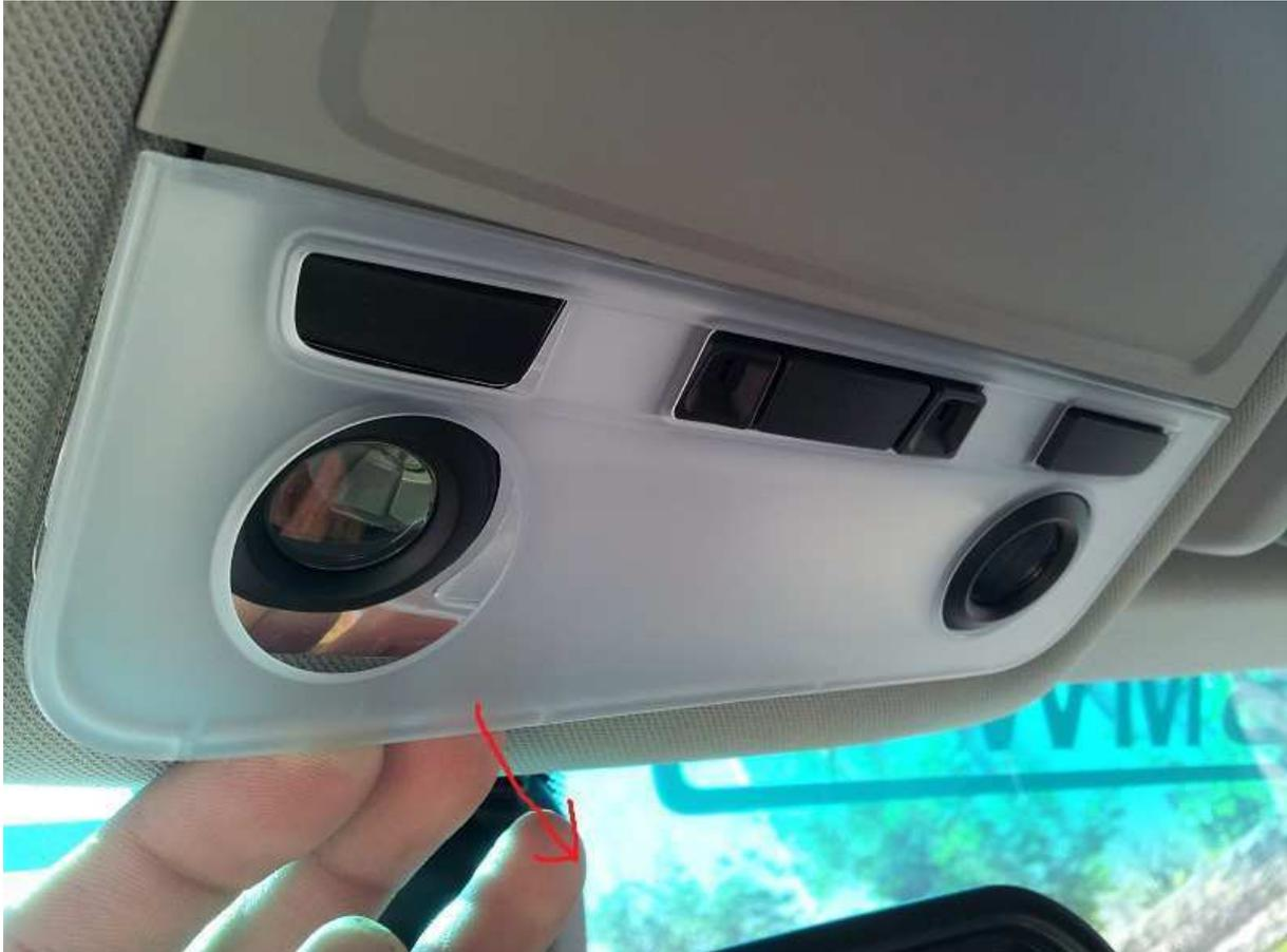
Nun muss die weiße Blende entfernt werden, am besten mit einer Checkkarte oder diesem Haken von vorne aushebeln.
